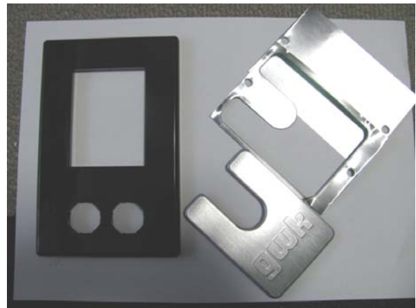
図12 gwk のブースで成形実演されていた成形品 左: 高光沢ウェルドレス 右: アルミンサート成形
