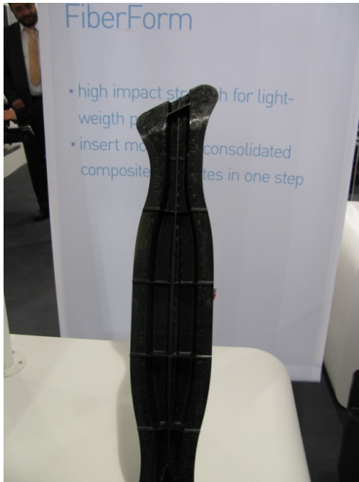
図7 KraussMaffei のブースで成形実演していた ガラス長繊維強化部品 ガラス長繊維強化シートを予備加熱して 金型にインサートし、リブを射出する
