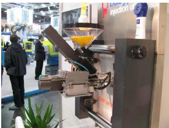
図3 Baby Plast 社の金型取り付け用 射出ユニット
