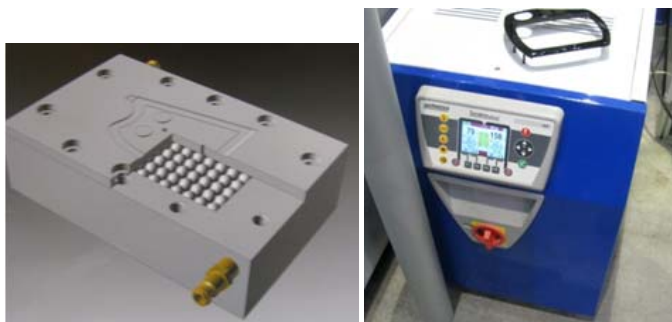
図16 BF Mold 用金型イメージ図と温調装置
