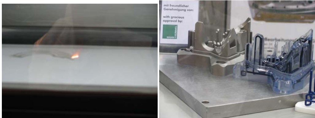
図18 LBC のレーザー焼結による 3 次元冷却配管 左:レーザーで焼結している様子 右:金型入れ子と模型
